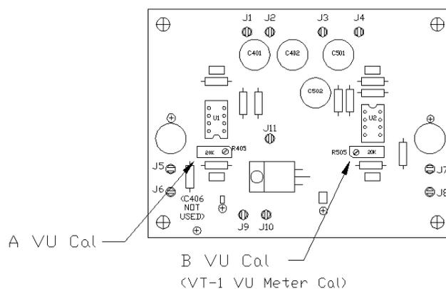
**Fig. 5 VU Meter Amplifier PCB**
